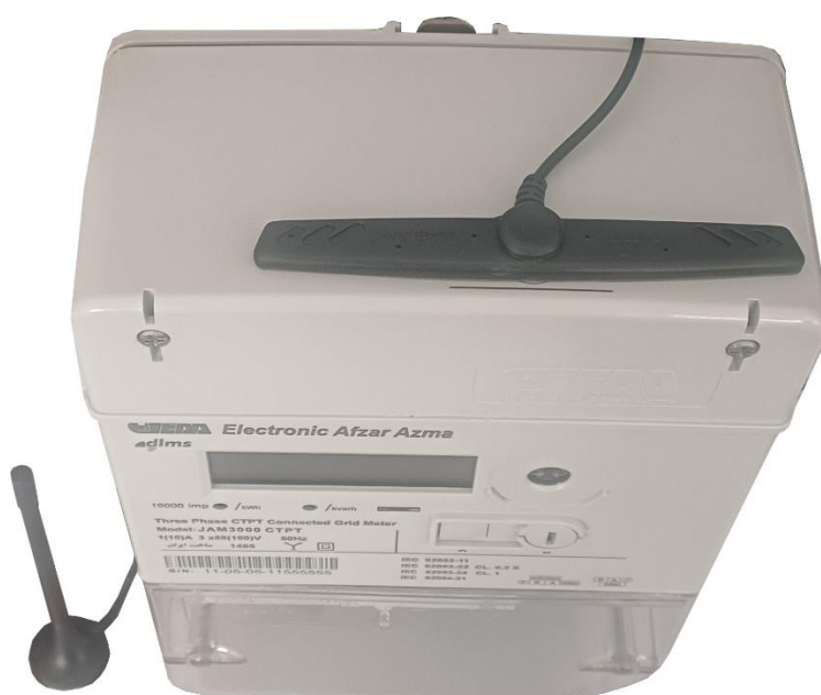
شکل ۱۱: کنتور با آنتن GSM
